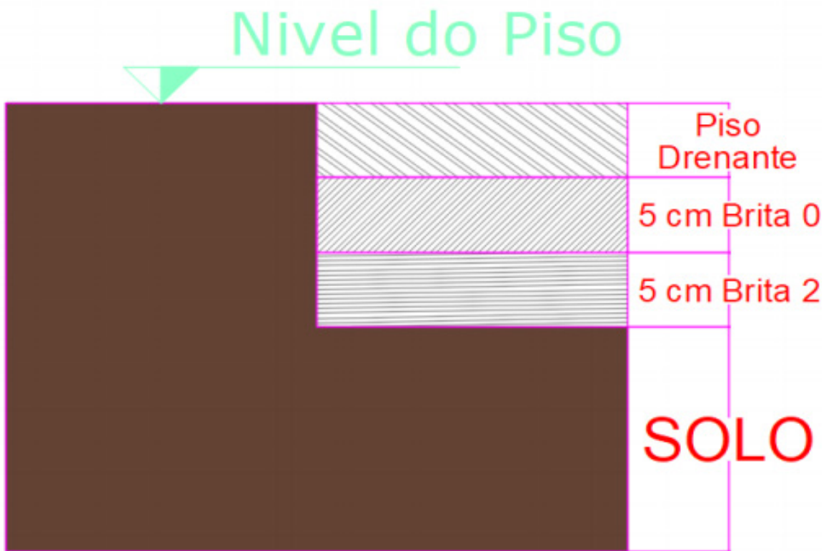
Figura 2 - Corte transversal da instalação do piso drenante
