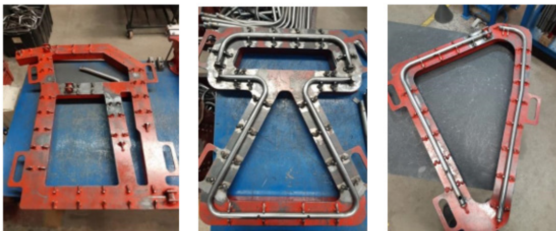
Figura 1 – Gabaritos de conferência de peças cadeira de rodas e banho.
