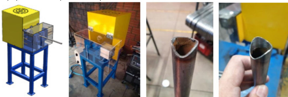
Figura 2 – Máquina de limpeza de escórias deixadas pelo processo de corte à plasma, e as peças antes e depois das limpezas.
