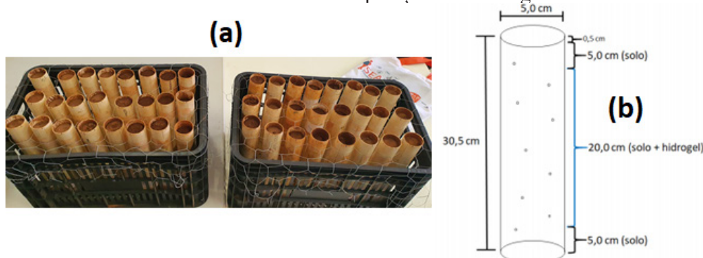
Figura 1. (a) Foto dos tubetes de PVC. (b) Representação das dimensões dos tubos de PVC e formato “sanduichado” das disposições do hidrogel.
